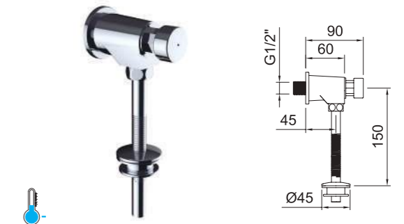
Grifo temporizado mural urinario con cartucho M28 y <7 segundos. Wall-mounted delay action tap urinal with aerator, cartridge M28 and <7 seconds. Robinet temporisé urinoir mural avec cartouche M28 et <7 secondes.
