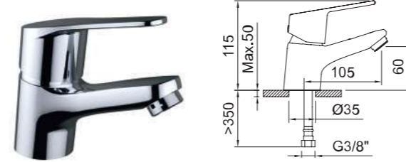
Lavabo monomando con aireador y flexibles 3/8" >350mm. Single-lever basin mixer with aerator and flexible hoses 3/8" >350mm. Mitigeur lavabo avec aérateur et flexibles de raccordement 3/8" >350mm.
