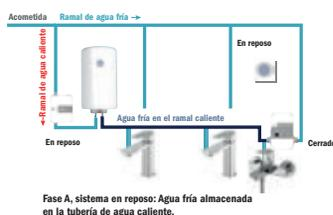
Una vez activado el sistema, el Bypass y el Módulo de Potencia se ponen en marcha para proceder a la recirculación del agua que está acumulada desde la caldera al punto de uso o grifo.
