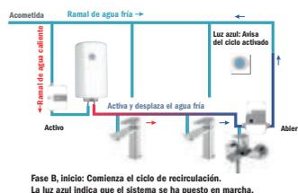
El agua se va calentando y cuando está a la temperatura deseada, la luz LED roja indicará que el proceso ya ha terminado y se dispone de agua caliente.
