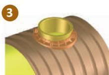
3 Monte el asiento (E), introduciendo en su interior la junta hermética (F), y gírela oportunamente hasta que adhiera en todos sus puntos al perfil corrugado externo del tubo (H).
