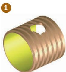
1 Realice un orificio (G) con diámetro de 169 mm o 216 mm (según el tipo de Injerto-Clip a instalar) con una herramienta adecuada para el material que debe perforar.
