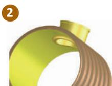
2 Después de preparar el tubo, introduzca la junta hermética (F) en el orificio (G) y gírela hasta que la superficie de su borde hermético se adhiera perfectamente a toda la superficie interna del tubo.
