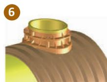
6 Controle con los dedos de una mano la perfecta adherencia de la junta hermética (F) a la pared interna del tubo. A continuación, enrosque los tornillos (C) y vuelva a controlar la adherencia de la junta hermética (F).
