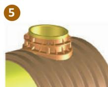
5 Una vez que ha introducido la brida de tracción (D) y asegurado su unión con el borde superior de la junta hermética (F), coloque los cuatro tornillos (C) en los orificios de brida de tracción (D) y enrósquelos hasta el asiento (E).
