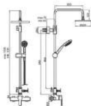
Mezclador monomando, telescópico para ducha JET. Mango ANTI-CAL de 3 posiciones. Rociador ANTI-CAL INOX de 3 mm
